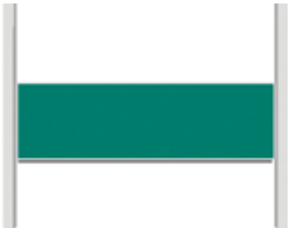
Pilon magasság: 270 cm. Függőlegesen mozgatható tábla – mozgatási alsósík padlótól a tábla alsó széle 15 cm, mozgatási felsősík a pilon magasság –1 cm.
